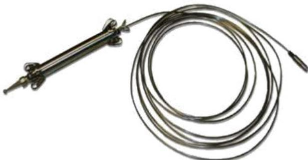
*Блок детектирования для пускового и рабочего диапазонов*
